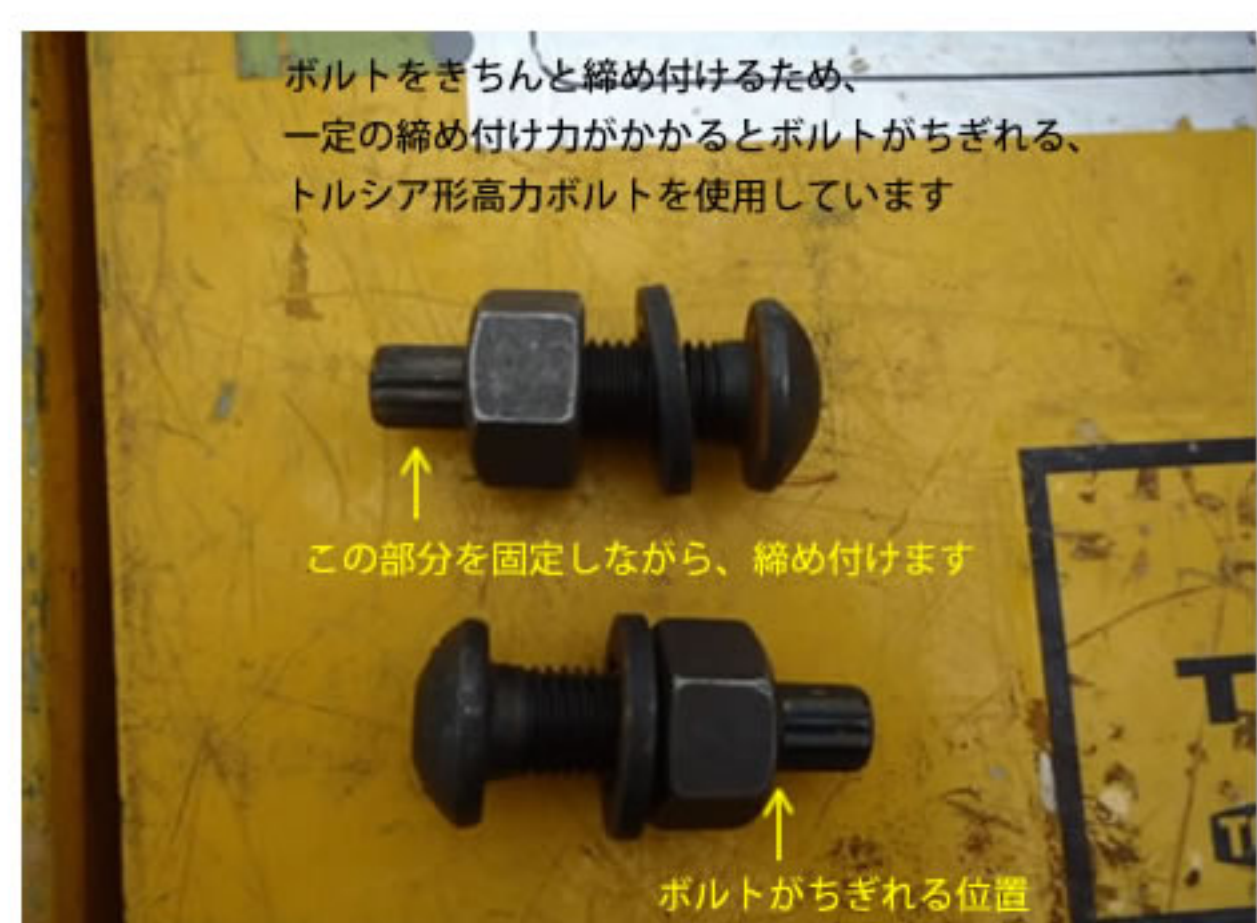
⑥ 鉄骨を固定する本ボルト
